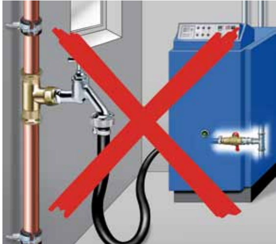
Diese unzureichende Sicherungskombination gefährdet das Trinkwasser und ist nicht mehr zulässig!
